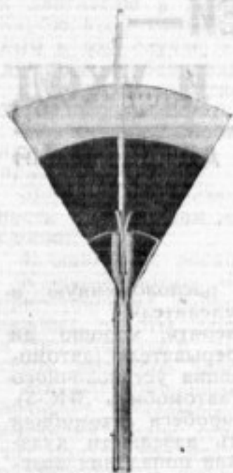
Рис. 2. Динамометр для определения давления пружины прерывателя
